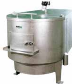
Centrifugadoras para la limpieza y escalde de estómagos, patas, cabezas, etc.
