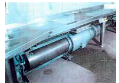
Empujadores hidráulicos para transporte de grasas y subproductos
