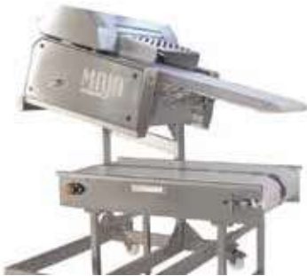
Descortezadoras BXAplus y BXMplus montadas sobre chasis especiales para integrarlas en la línea de proceso
