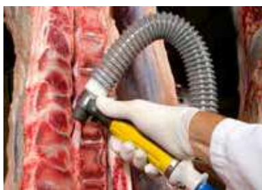
TrimVac 645i Aspiración de residuos de grasa de las canales de vacuno y porcino
