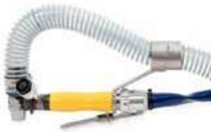
Quantum TrimVac Aspiración de la médula y duramadre de las canales de vacuno
