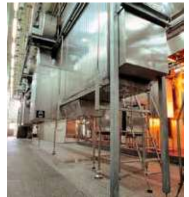
Túnel de escalde vertical mediante vapor
