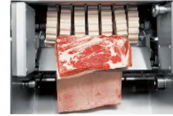
ASB 600 Descortezadora manual/automática con ancho de corte de 400 mm para pequeñas y medianas industrias
